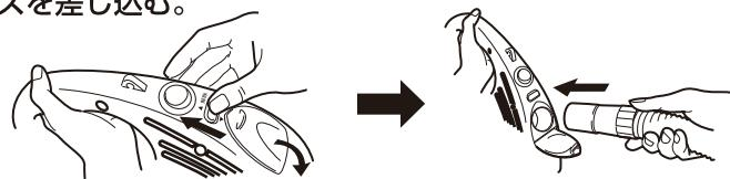
3. 吹出しホースの先端をそのまま使用するか、すきまノズルをホースの先端にセットして使用する。(吹き出す力を弱くしたい場合は、ホースの先端をそのまま使用してください。吹き出す力を強くしたい場合は、すきまノズルを使用してください。)
